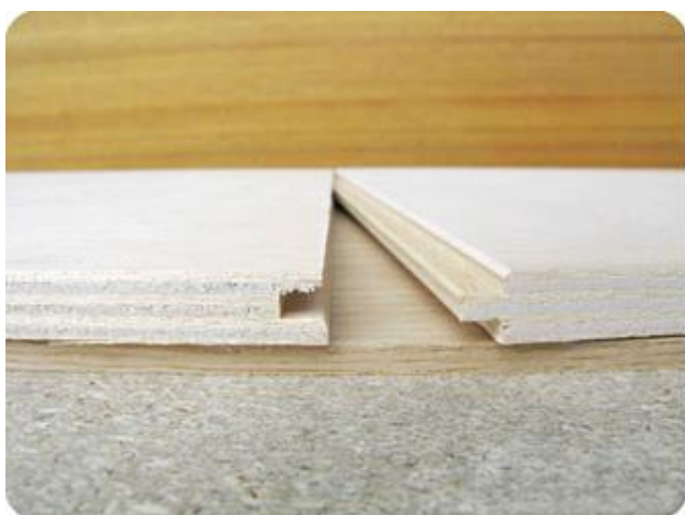
sistema di supporto brevettato a mattonella: particolare dell'incastro degli elementi di supporto in fase di incollaggio alla lamella
